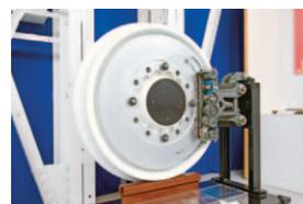
ライニングには分割した焼結合金を使用。時速300kmを超える高速度から、安定したブレーキ性能を発揮してくれる
