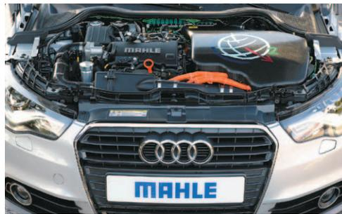
部品・モジュール開発・製造以外に、エンジニアリングサービスも力を入れているマーレがレンジエクステンダを開発。
