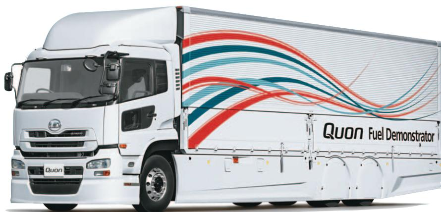
Systems）エコ運転支援装置も最新のタイプが導入された。GPSや地図データを活用することで走行ルート上、前方の坂道やカーブを認識し、より積極的に省燃費運転を支援する革新的システムが装備されたのだ。これによってより早いタイミングから燃料カットを働かせ、より長い
